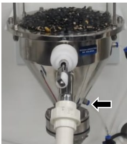
Figura 28 – Posição da queda de pressão mensurada
